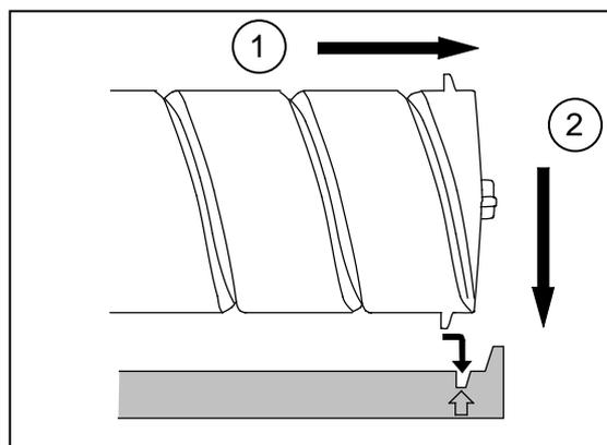
9. Поверните картридж с тонером в направлении стрелки по крайней мере на 180 градусов. (Новый картридж плотно закрыт, чтобы избежать просыпания тонера во время транспортировки)
