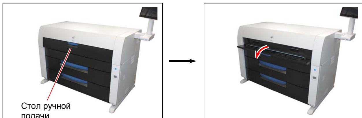
7. Удерживая двумя руками, выдвиньте на себя верхний блок принтера.
