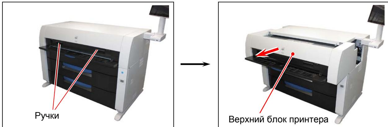
3. Поднимите вверх оба рычага и сдвиньте верхнюю крышку назад.
