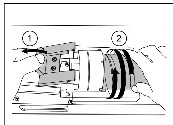
5. Удерживая рычаг (1) в нажатом положении, сначала приподнимите левый край картриджа, а затем извлеките картридж из принтера.
