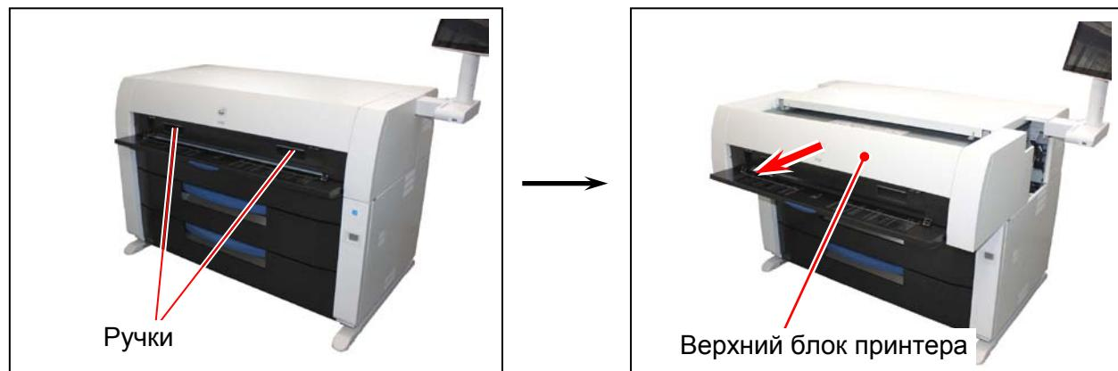
8. Поднимите вверх оба рычага и сдвиньте верхнюю крышку назад.
