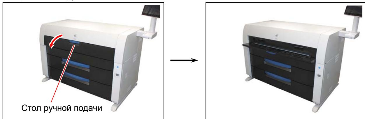
2. Поместите лист на стол в соответствии с нанесенными метками форматов и подайте внутрь принтера. После того, как лист будет подан на определенное расстояние, принтер автоматически подхватит его и установит в нужное положение.
