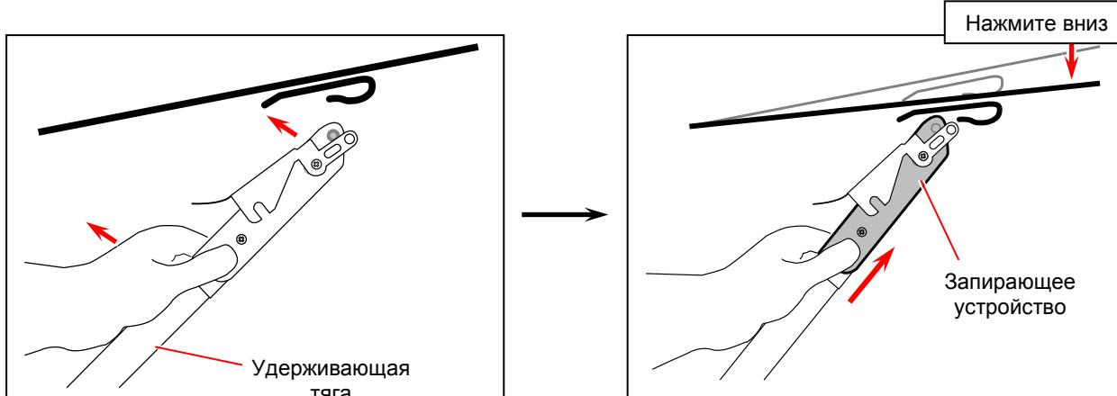
14. Полностью опустите запирающий рычаг вниз, чтобы зафиксировать лоток.
