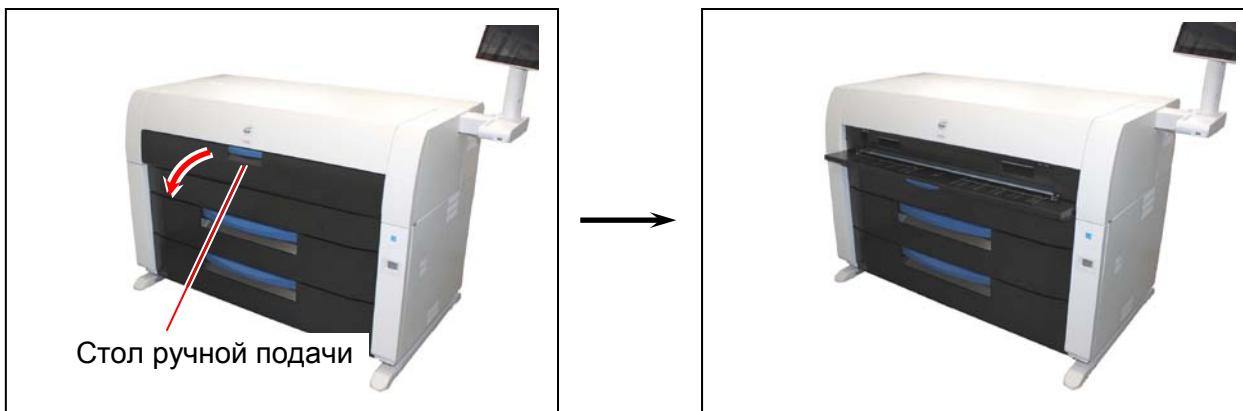
2. Удерживая двумя руками выдвиньте на себя верхний блок принтера.
