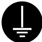
Для предотвращения поражения электрическим током подключайте аппарат только к розеткам, имеющим заземление. Если таких розеток нет, то обратитесь к электрикам, обслуживающим Ваши помещения.
