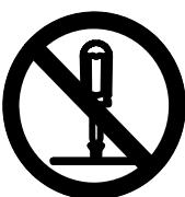
1. Не откручивайте шурупы и винты, если об этом нет указаний в руководстве, так как аппарат содержит детали под высоким напряжением и это может вызвать поражение электрическим током.
