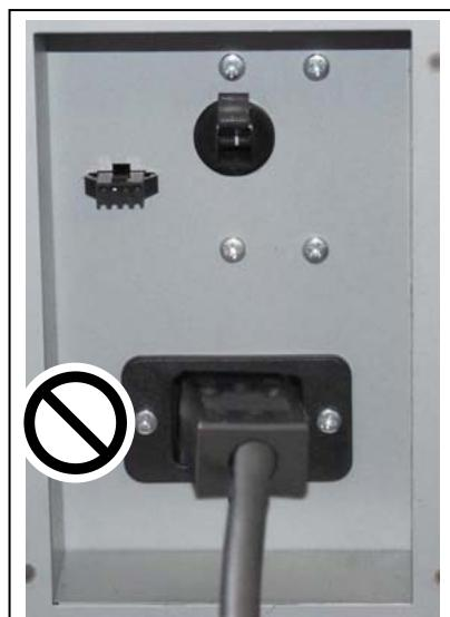
3. Если принтер надолго отключается по причине длинного отпуска или транспортировки, выключите автоматический отключатель и извлеките сетевой шнур из разъема принтера.
