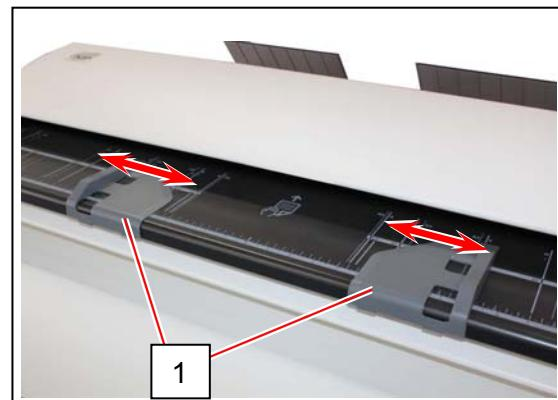
3. Поместите оригинал на стол оригиналов изображением вверх. Далее продвиньте оригинал вперед под блок сканера вдоль направляющих оригинала.
