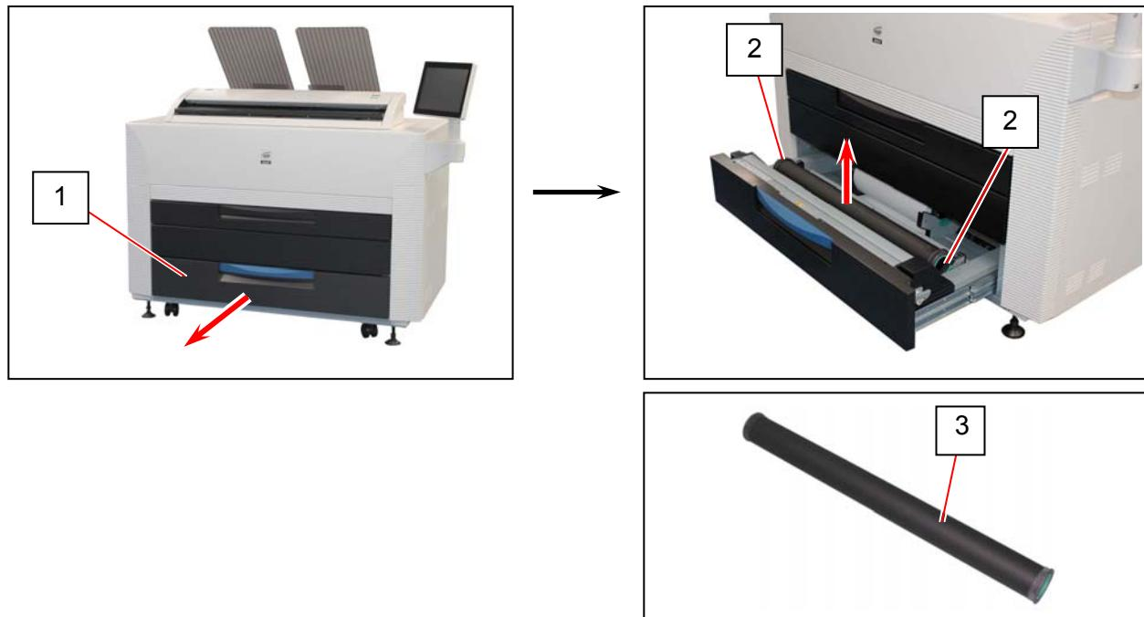
2. Поднимите рычаг (4) на торцевом фланце (2) и снимите 2 торцевых фланца (2) с обоих торцов втулки рулона (3).
