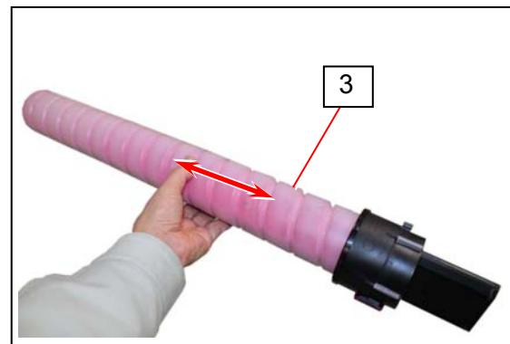
4. Удерживая черную часть картриджа отверстием подачи тонера вверх, поверните корпус картриджа (белую часть) в направлении показанной стрелкой более чем на 3 оборота. Данное действие откроет отверстие подачи тонера.
