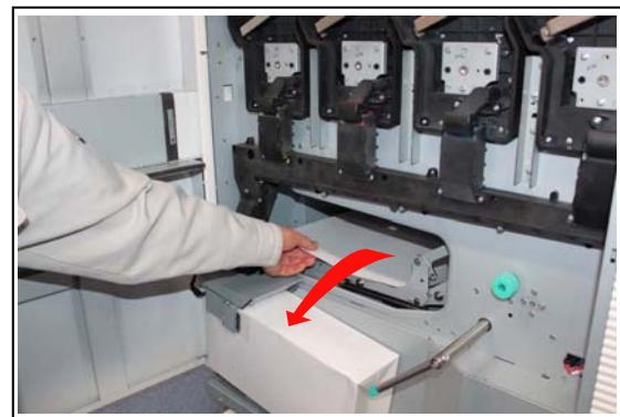
4. В случае если материал зажат роликами и не может быть извлечен, поверните ручку протяжки материала (3) чтобы материал продвинулся к транспортному блоку и затем извлеките его.
