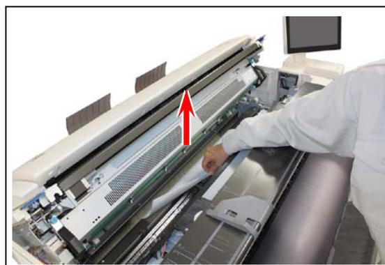
3. Положите руки на задний обод блока сканера, чтобы держать верхний блок. Нажмите весь блок вниз в направлении стрелки.
